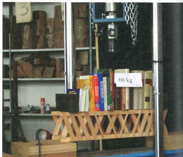
Una delle strutture preparate, sottoposta al carico statico, prima della prova di rottura, per il tema "Lo Scaffale", di qualche anno fa.
